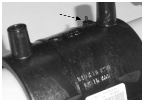
Schweißindikator (Pfeil) zeigt an, dass Heizwendel-Muffe verschweißt wurde.
