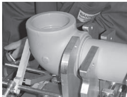
Abb. 11 Maschinenschlitten bis Hubende zusammenfahren
